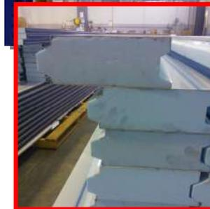
*La puerta ThermicRoll® Spiral Door ISO 80 está diseñada para ambientes refrigerados: el espesor de los paneles garantiza las mejores prestaciones en términos de aislamiento térmico y acústico.
